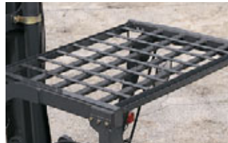
Головное ограждение с передними/задними водостоками
