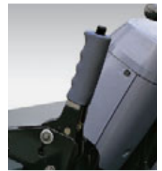
Стояночный тормоз с храповиком
